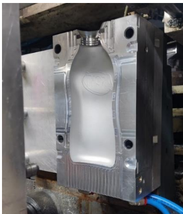
Figure 3.6. Asevi's bottle extrusión blow moulding mould.
